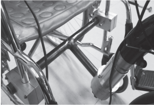
図26 改良後の車いす側アダプタ
