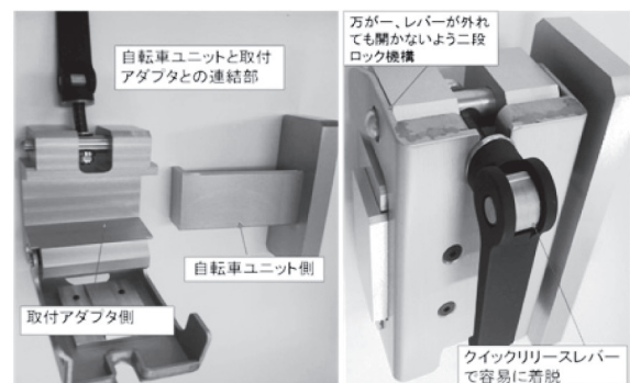
図21 接続装置の詳細
