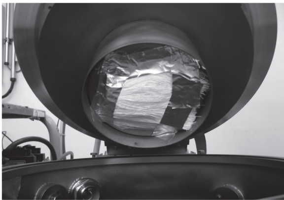
図14 チャンバー上部に取り付けた中空糸
