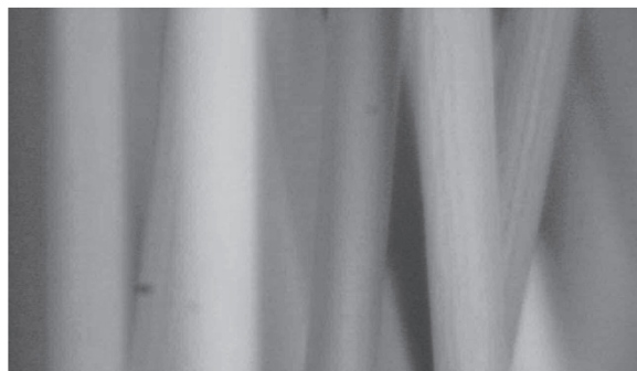
図17 Ce薄膜をスパッタした中空糸表面 (200倍)
