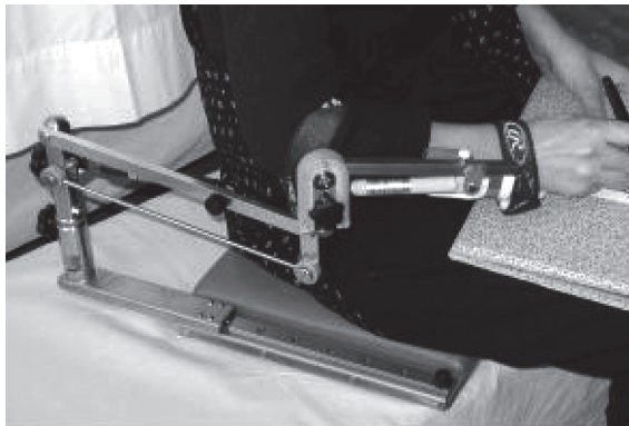
図2 アームバランサーの使用例
