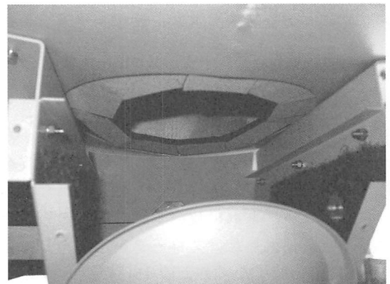
図10 電波吸収体装荷時のアンテナ給電部
