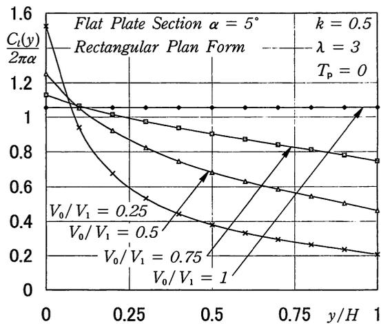
図3 局所揚力係数分布 ( $V_0/V_1$ の影響)
