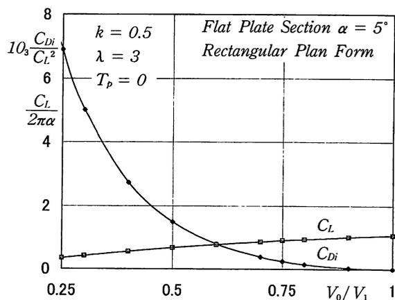
図6 全揚力係数と誘導抗力係数 ( $V_0/V_1$ の影響)
