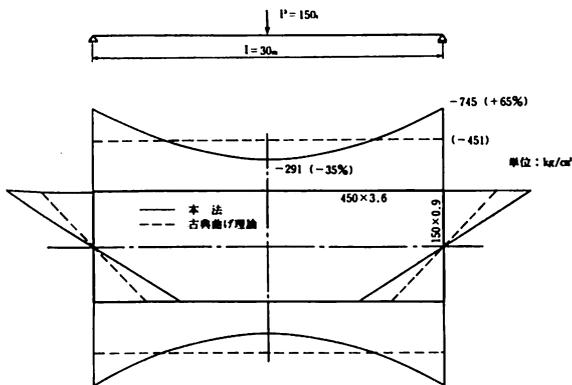
図-6 軸応力分布 (CASE-[C])
