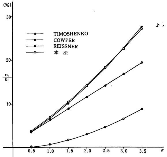
図一 3 箱形断面の形状変化に対する影響 (CASE-[B])
