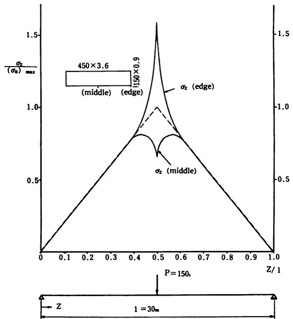
図-7 軸応力の軸方向変化 (CASE-[C])
