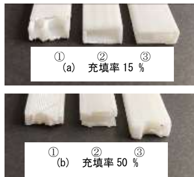
図 12 試料の破断面
