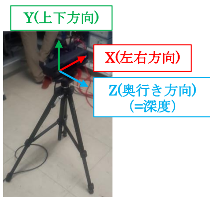
Fig. 2.6 Kinect v2 座標系
