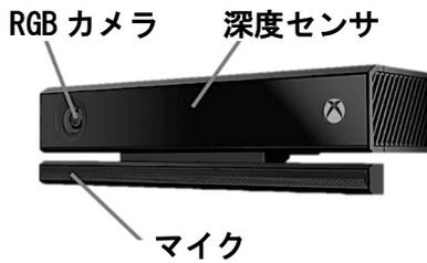
Fig.1 Kinect v2
