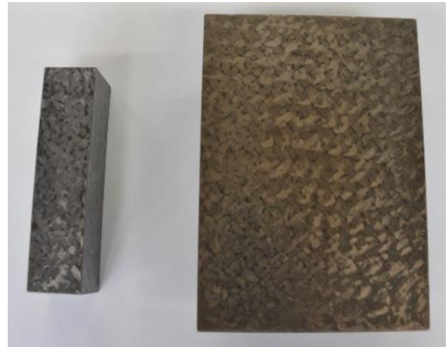
図1 実習製品(左)と摺り合わせ定盤(右)
