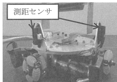
図4 測距センサ搭載位置
